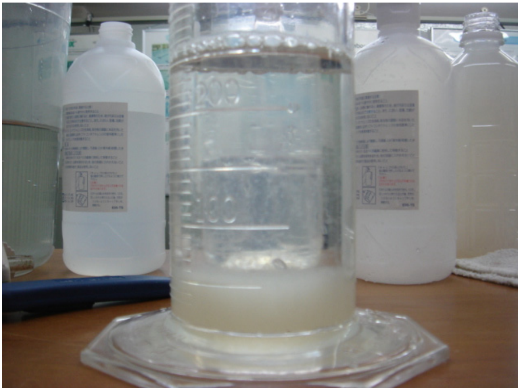
凝集沈殿状態写真 パターン2、MIOX 10mg/L PAC 50mg/L
